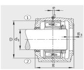
设计类型 A ① 定位轴承 TS-AF ② 浮动轴承 TS-AL
